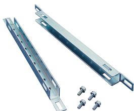
Il s'agit de rails de montage installés sur le renfort de porte. Elles sont utilisées pour fixer des accessoires sur la porte. D'une épaisseur de 1,5 mm, elles sont en acier avec une surface revêtue. Supporte des charges jusqu'à 50 kg.
