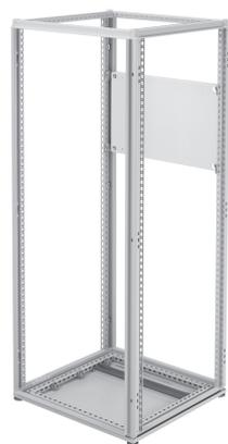
Les panneaux de montage partiels sont en acier brut conducteur d'une épaisseur de 2,5 mm et comportent des pattes de fixation des quatre côtés. Les panneaux peuvent être montés à la verticale et dans la profondeur souhaitée par pas de 25 mm à l'aide des traverses de profondeur disponibles en option (à commander séparément). La visserie de fixation est fournie.
