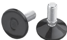
Les quatre pieds vérins servent à compenser les sols irréguliers. Ils peuvent être montés sous un bâti ou un socle plein. Les pieds vérins sont en acier zingué. L'embout du pied est en plastique afin d'éviter de rayer les surfaces. Réglables en hauteur (entre 17 mm et 35 mm), ils sont munis d'une articulation sphérique. Quatre pieds vérins supportent un poids maximal de 450 kg.
