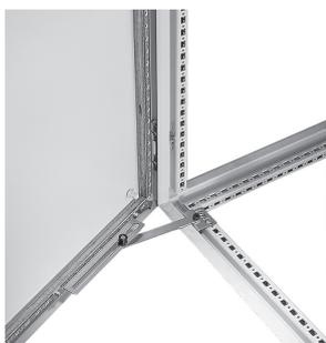
Le compas de porte bloque l'ouverture de la porte à 130 degrés. Le kit comprend un support de guidage à monter sur la partie supérieure ou inférieure de la porte et une tringle à fixer sur le bâti. Le compas de porte est zingué, se monte sans aucun perçage, et est livré avec la visserie de fixation. Non adapté aux portes avec charnières 180 degrés. Les équerres des portes-fenêtres comportent des points de perçage pour le montage du compas de porte.
