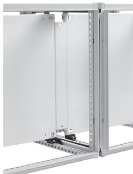
Permet d'obtenir une surface continue du panneau pour les rangées d'armoires accouplées. Le panneau intermédiaire est inséré entre des panneaux de montage de même hauteur. Il peut être monté à l'avant ou à l'arrière et comporte des perforations pour la mise à la masse ainsi que la visserie de fixation. Les panneaux de montage conducteurs sont en acier brut galvanisé.
