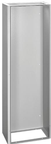
Les armoires de câblage sont fabriquées en acier de 2 mm d'épaisseur avec une surface recouverte de poudre structurée gris clair (RAL 7035). Elles permettent le passage de câbles à travers les flancs l'armoire. Un toit et un fond ouverts permettent d'accéder aux câbles et de les gérer.
