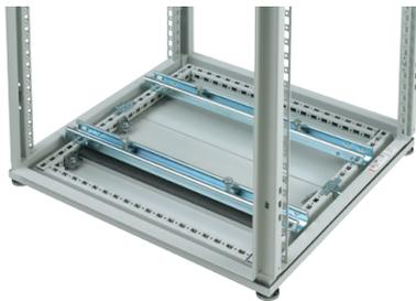
Les rails de transformateur servent à monter des composants lourds et des transformateurs dans la partie inférieure d'une armoire.
