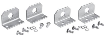
Les équerres sont utilisées pour une répartition optimale des charges lors du soulèvement des armoires avec des composants et des câbles d'un poids maximum de 450 kg par emplacement de montage. Elles se montent sur la partie supérieure des coins du bâti, sans avoir à retirer le toit. Le kit comprend deux équerres ainsi que quatre boulons et quatre rondelles. Les équerres sont en acier galvanisé et ont une épaisseur de 7 mm.
