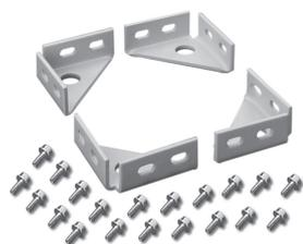
Elles constituent une méthode de construction pour la fixation au sol d'un bâti ProLine. Elles sont adaptées à toutes les hauteurs de bâti. D'une épaisseur de 2,5 mm, elles sont en acier zingué. Le lot comprend quatre équerres et la visserie de fixation nécessaire.
