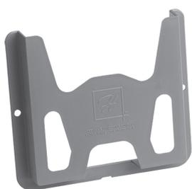
Permet de ranger des plans de câblage, des instructions de montage et d'autres documents dans l'armoire. Les pochettes à document avec face arrière adhésive sont posées à l'intérieur de l'habillage de l'armoire. Pièces de fixation fournies. Les pochettes à document gris foncé sont en thermoplastique résistant et disposent de découpes pour pouvoir accéder facilement aux documents à tout moment et que ceux-ci soient bien visibles.
