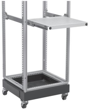
L'étagère-bâti télescopique permet d'accéder facilement aux appareils qui sont montés sur l'étagère. L'étagère est fabriquée en acier d'une épaisseur de 1,5 mm avec des supports en acier d'une épaisseur de 2 mm. Finition poudre structurée gris clair (RAL 7035). L'étagère est montée sur les montants avant et arrière. Visserie de fixation fournie. La charge admissible est de 50 kg.
