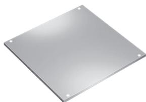
Les tôles de toit pleines sont utilisées pour la fermeture de l'ouverture de toit dans les bâtis. La surface des tôles d'acier est recouverte d'une poudre structurée gris clair (RAL 7035). Les tôles de toit sont en acier galvanisé et ont une épaisseur de 1,5 mm.
