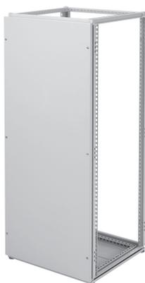
En remplacement d'une porte simple, utilisez une pièce d'habillage pleine à l'avant et à l'arrière du bâti. Les pièces d'habillage pleines sont fixées au bâti à l'aide de vis semi-noyées. Des étriers adéquats sont fournis pour pouvoir aligner facilement les vis de fixation. Les pièces d'habillage sont recouvertes d'une poudre structurée gris clair (RAL 7035). Elles sont pourvues d'un joint en mousse d'uréthane et de deux goujons de mise à la masse. Pièces de fixation fournies.
