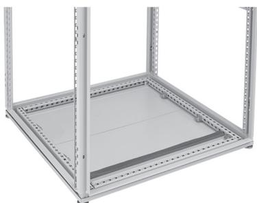
Le jeu de tôle plancher comprend les éléments suivants : tôle plancher de 1,5 mm, finition poudrée (RAL 7035) et avec joint en mousse ; trois plaques d'obturation zinguées d'une épaisseur de 1,5 mm avec joint en mousse et bande adhésive ; et visserie de fixation.
