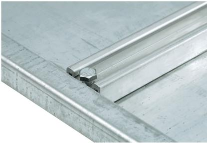
Les renfort pour parois servent à soutenir les panneaux de montage avec des charges lourdes, réduisant ainsi les vibrations provenant des composants. Montage possible sur bâti à porte simple et double. Les renforts peuvent être insérés dans des systèmes existants sans avoir à démonter le panneau de montage. Ils sont livrés par paire et sont en acier brut galvanisé.
