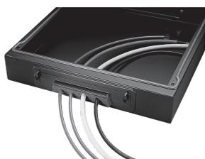
Convient à toutes les ouvertures passe-câbles dans les socles standard pleins de 100 mm de ProLine. A utiliser à la place des plaques d'obturation standard fournies avec le socle. L'ouverture pour le passage de câbles est recouverte d'un joint mousse et donc étanche à la poussière. D'une épaisseur de 2 mm, la plaque est en acier, finition poudrée noir foncé (RAL 9005).
