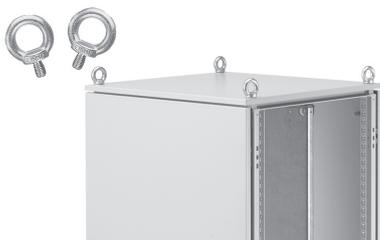
Les anneaux de levage sont utilisés pour soulever des bâtis ProLine modulaires ainsi que pour fixer les accessoires de toit ProLine au bâti. Les anneaux de levage sont vissés dans les coins du bâti. Disponibles par lot de quatre à surface revêtue.
